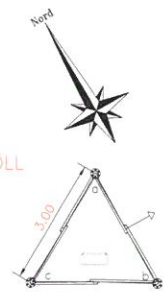
Pied de pylône Azimut: 91° Orientation
